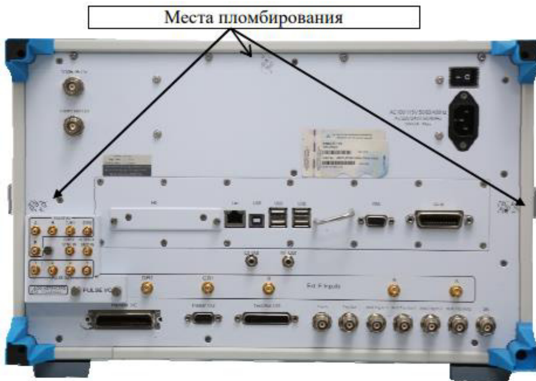
Рисунок 5 – Задняя панель ВАЦ 3672С (место пломбировки)
