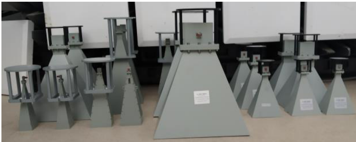
Рисунок 3 – Внешний вид комплектов эталонных и вспомогательных антенн
