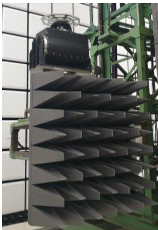
Рисунок 2 – Внешний вид прецизионного трёхкоординатного позиционера РЛТГ.411722.008
