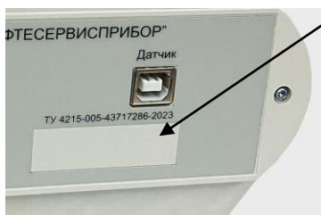
Рисунок 5а – Заводской номер на блоке обработки информации
