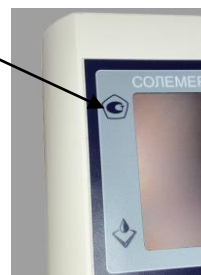
Рисунок 4 – Место нанесения знака утверждения типа
