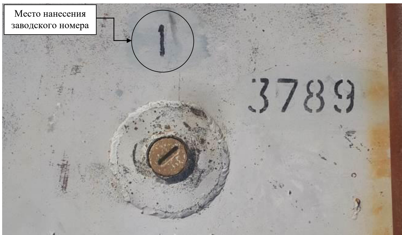
Р и с у н о к 3 – Общий вид замерного люка и места нанесения заводского номера
