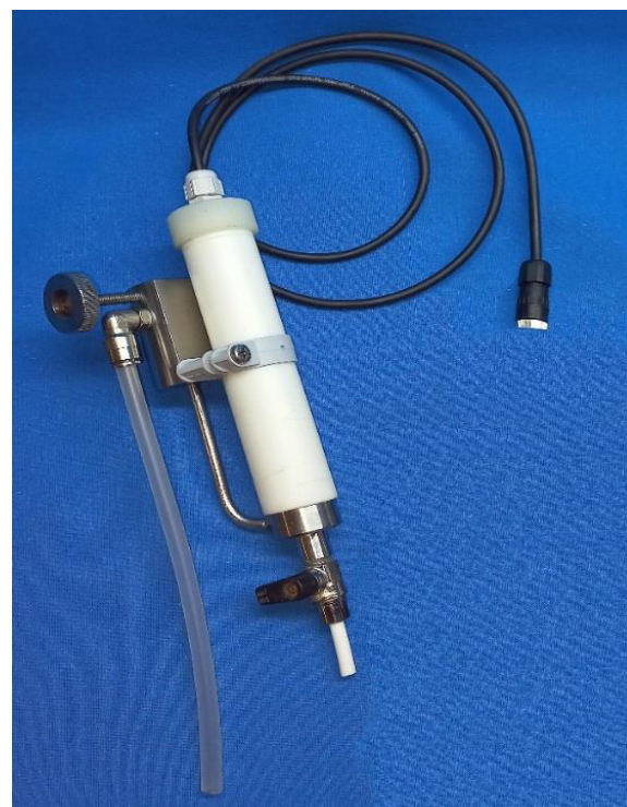
Датчик растворенного кислорода, используемый в исполнениях ДКНБ. 414310.001, -01, -03, -04
