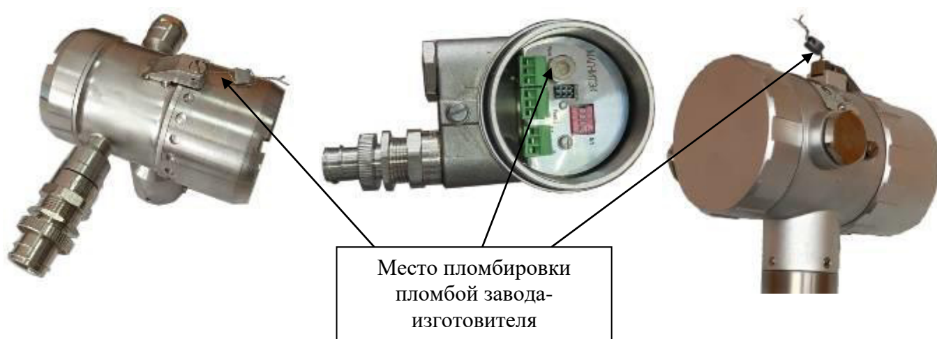
Рисунок 2 – Схема пломбировки электронного блока преобразователя от несанкционированного доступа, обозначение мест пломбировки пломбами завода-изготовителя
