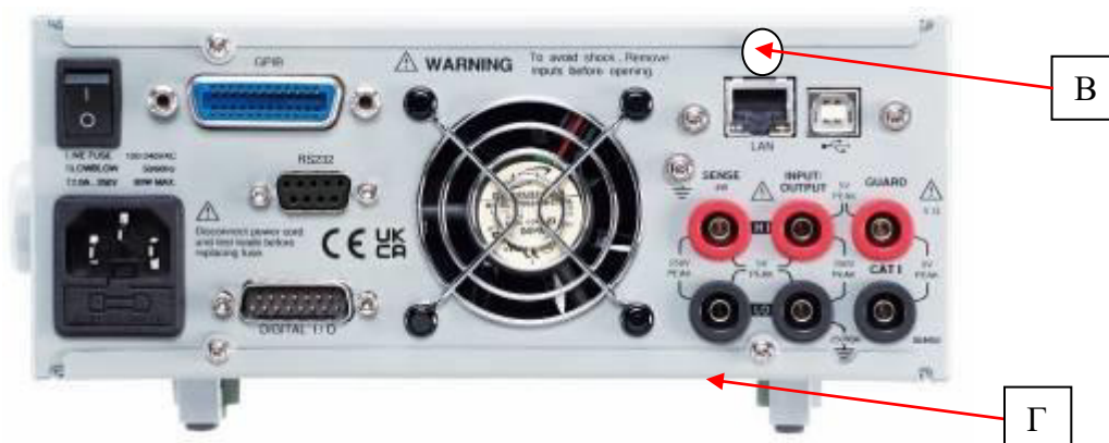
Рисунок 2 – Схема пломбировки от несанкционированного доступа (В) и место нанесения заводского номера (Г).
