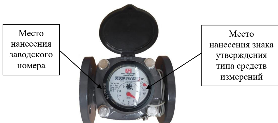
Рисунок 3 – Места нанесения заводского номера и знака утверждения типа средств измерений
