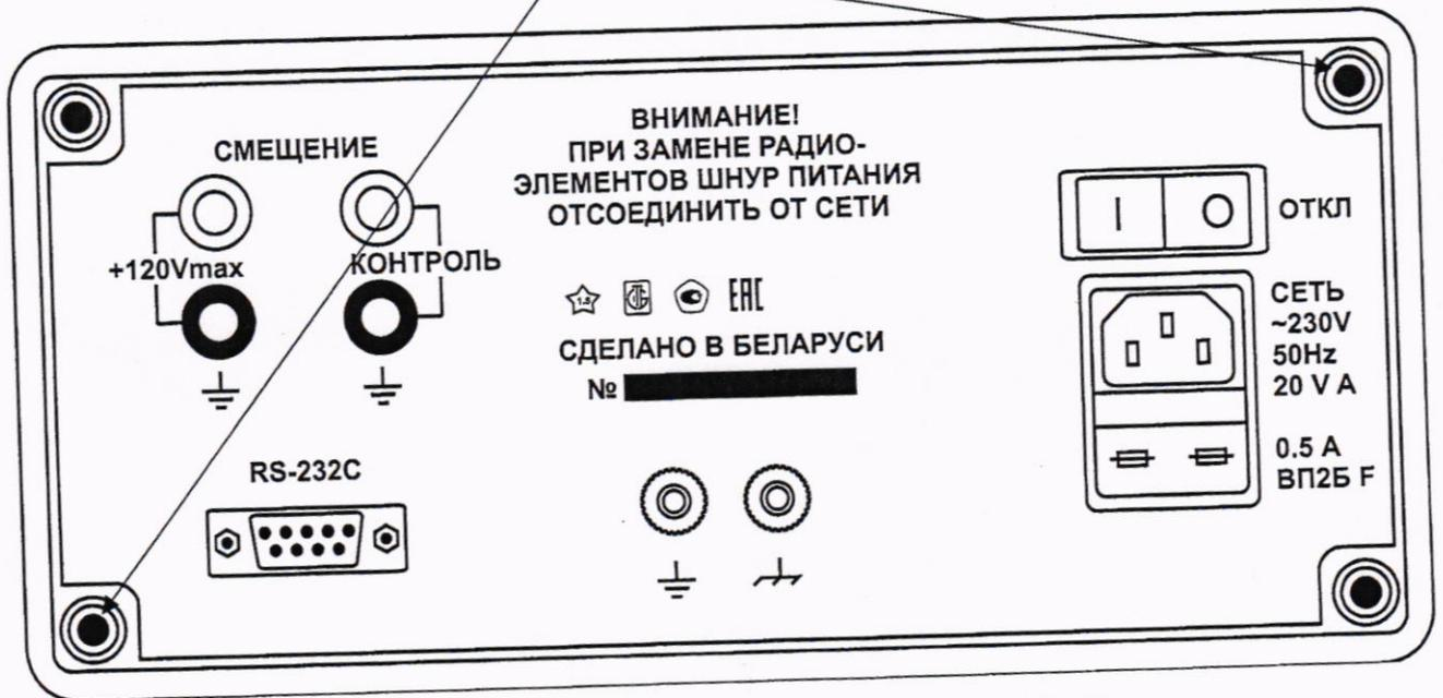
Рисунок 3.1 – Схема пломбировки от несанкционированного доступа
