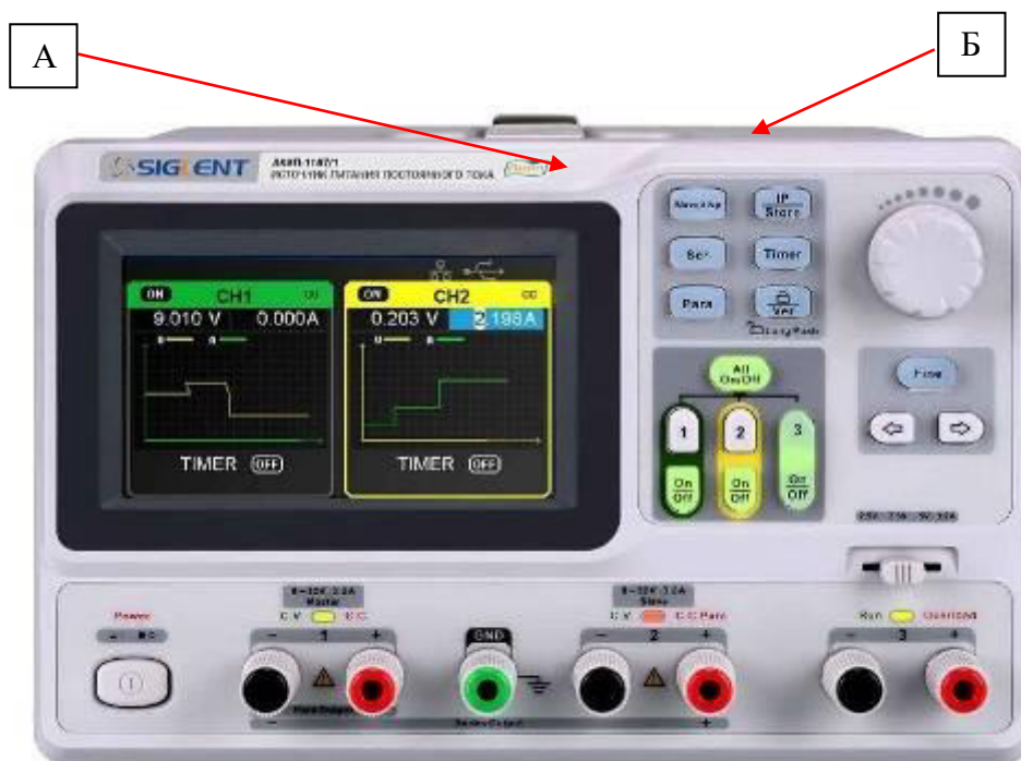
Рисунок 1 – Общий вид источников, места нанесения знака утверждения типа (А) и знака поверки (Б)
