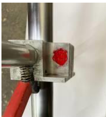
Рисунок 2 — Место пломбирования приборов для определения динамического модуля упругости несвязанных грунтов и оснований ГРУНТЕСТ
