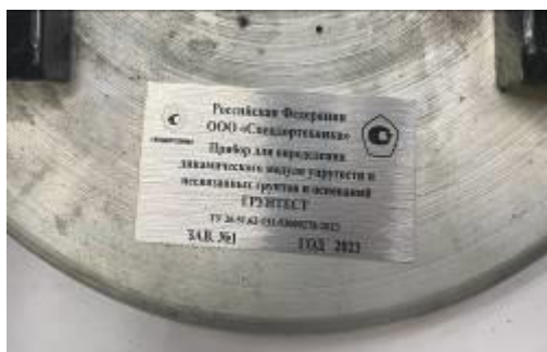
Рисунок 3 — Маркировочная табличка приборов для определения динамического модуля упругости несвязанных грунтов и оснований ГРУНТЕСТ с указанием заводского номера и знака утверждения типа
