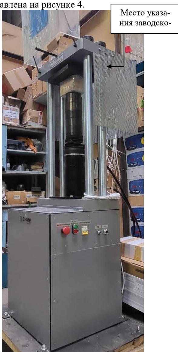
Рисунок 1 – Общий вид машин для испытаний ИП-1А модификаций ИП-1А-500, ИП-1А-1000, ИП-1А-1500, ИП-1А-250/1000, ИП-1А-250/1500, ИП-1А-500АБ, ИП-1А-1000АБ, ИП-1А-1500АБ
