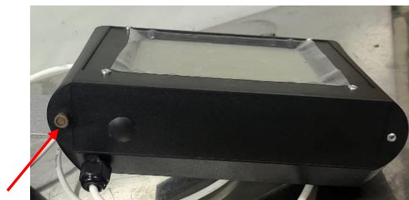
Рисунок 4 – Схема пломбировки крепежного винта микропроцессорного пульта управления
