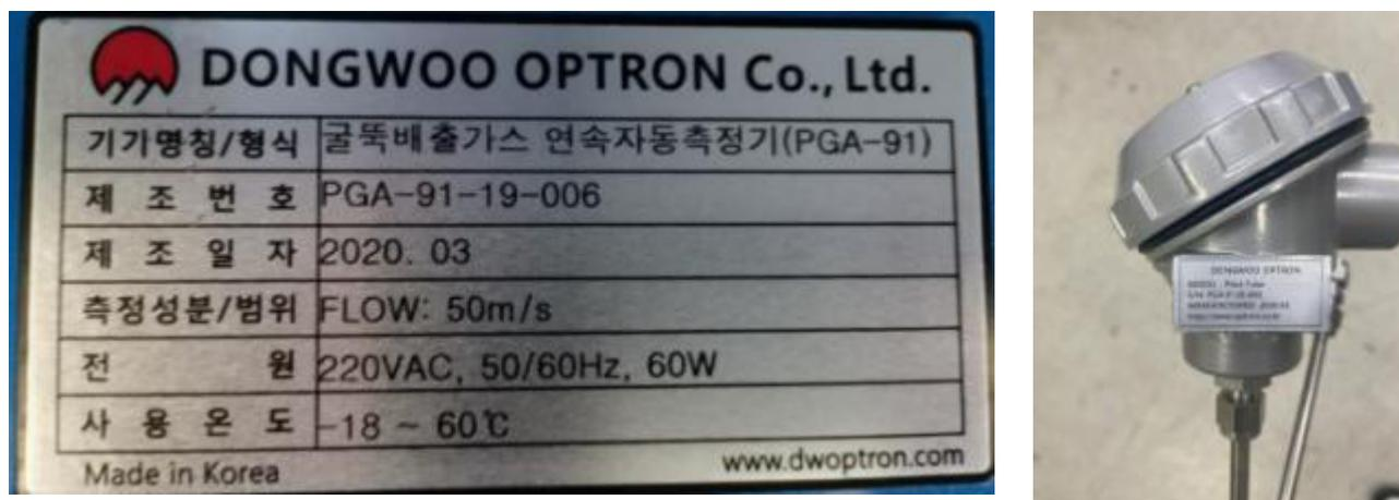
Рисунок 2 – Этикетка электронного блока и трубки Пито
