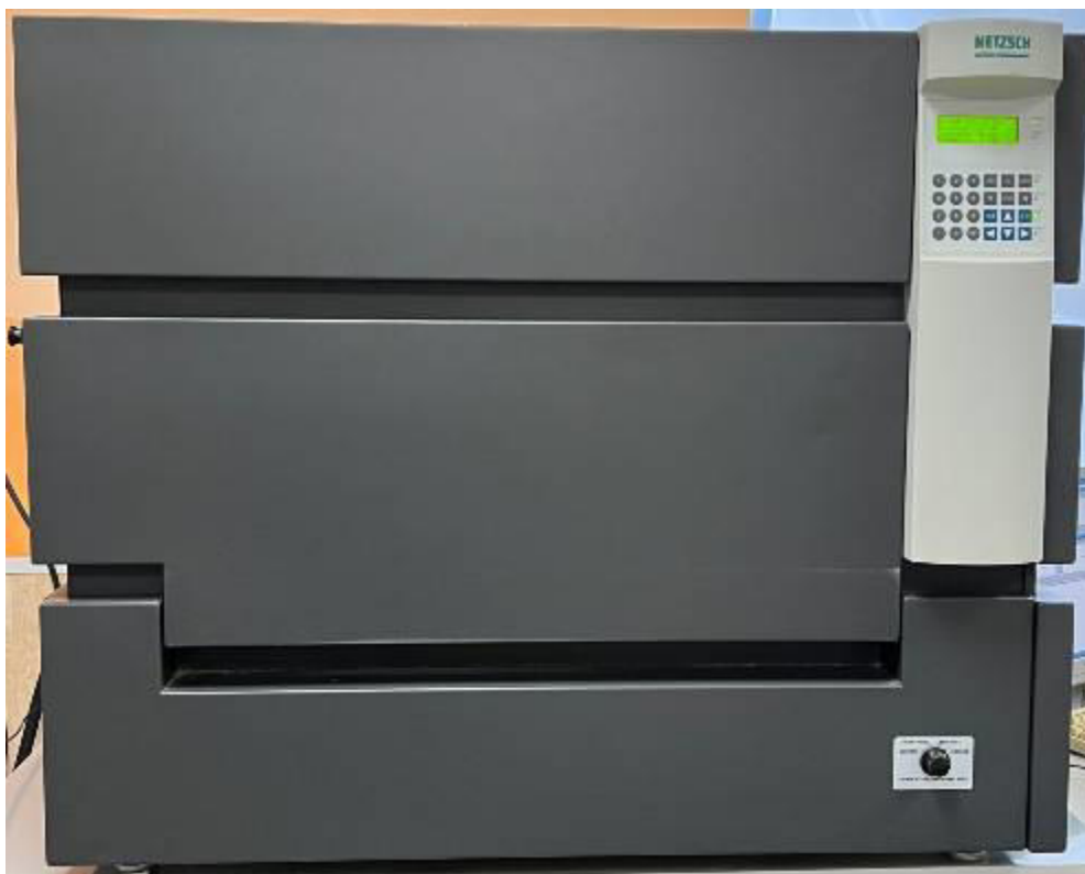
Рисунок 1 – Общий вид прибора для измерения теплопроводности HFM 436/6/1
