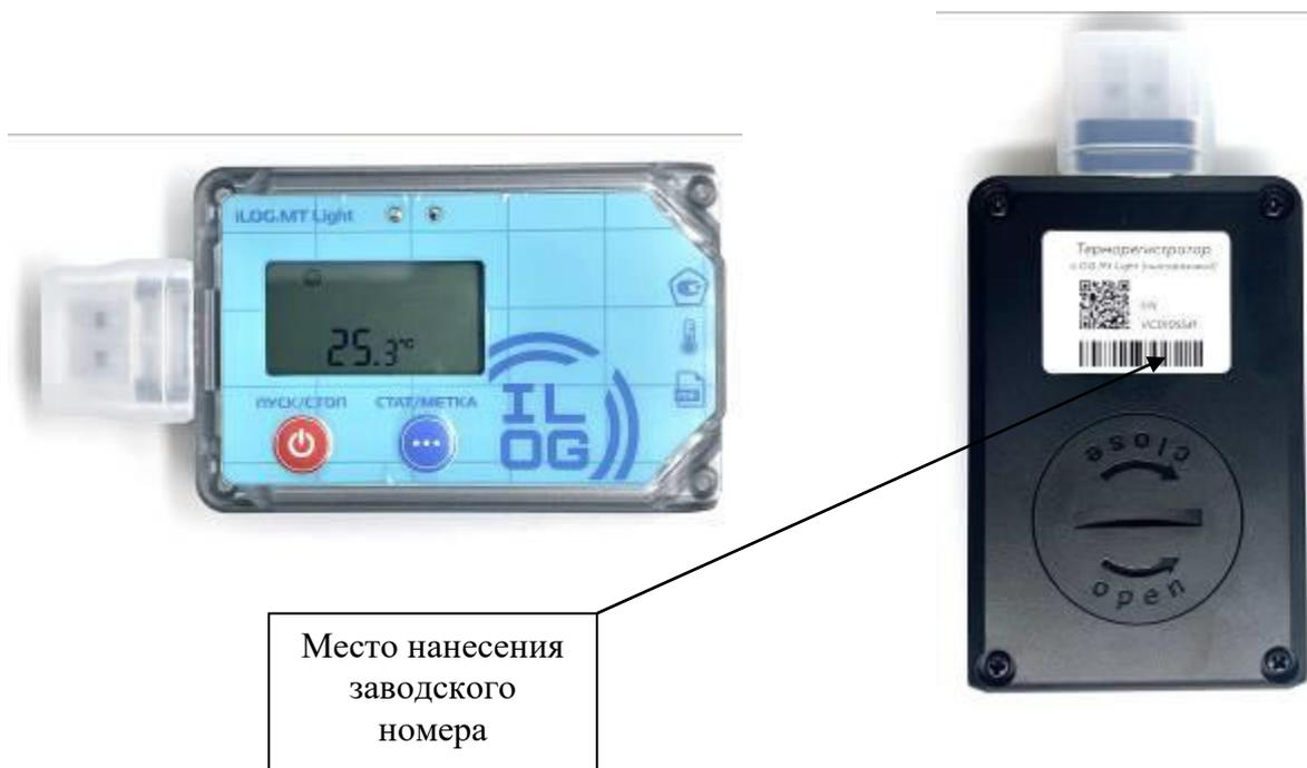
Рисунок 3 – Общий вид измерителей-регистраторов температуры iLog Mt(h) модели iLog.Mt Light
