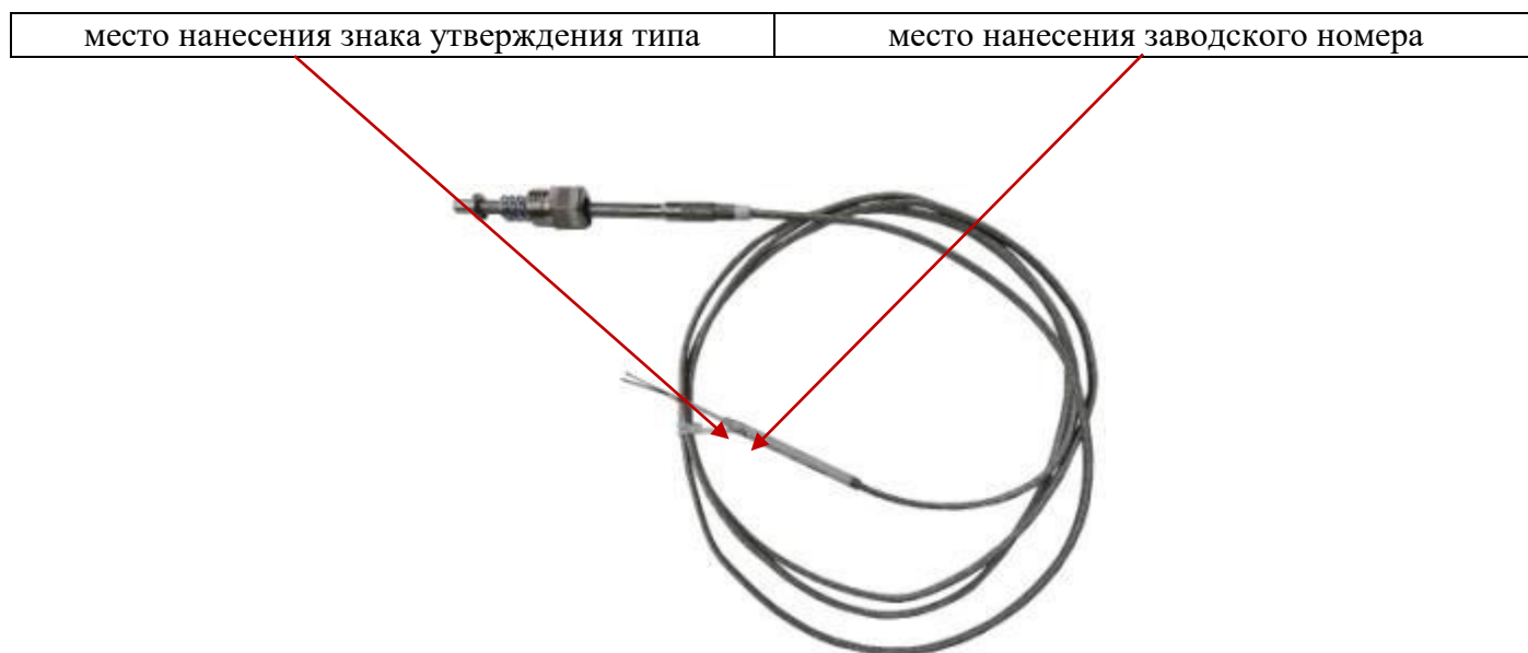
Рисунок 7 - Общий вид ТС модификации ТСП (ТСМ)/1-1388 (конкретный вид защитной арматуры, узла крепления, и выводов (соединителей или головки) приведен в эксплуатационной документации)
