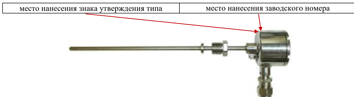
Рисунок 6 - Общий вид ТС модификации ТСП (ТСМ)/1-2288 с головкой Н80 (конкретный вид конфигурации арматуры, узла крепления и головки приведен в эксплуатационной документации)
