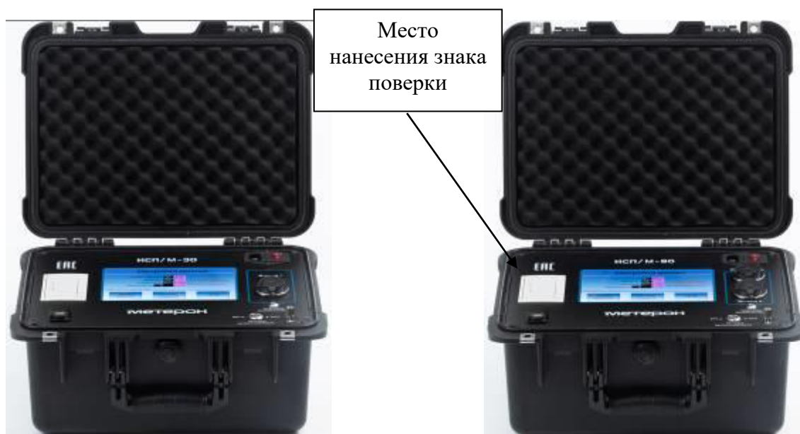
Рисунок 2 – Общий вид блока управления для установок модификаций Метерон ИСП/М-30, Метерон ИСП/М-40, Метерон ИСП/М-50, Метерон ИСП/М-60
