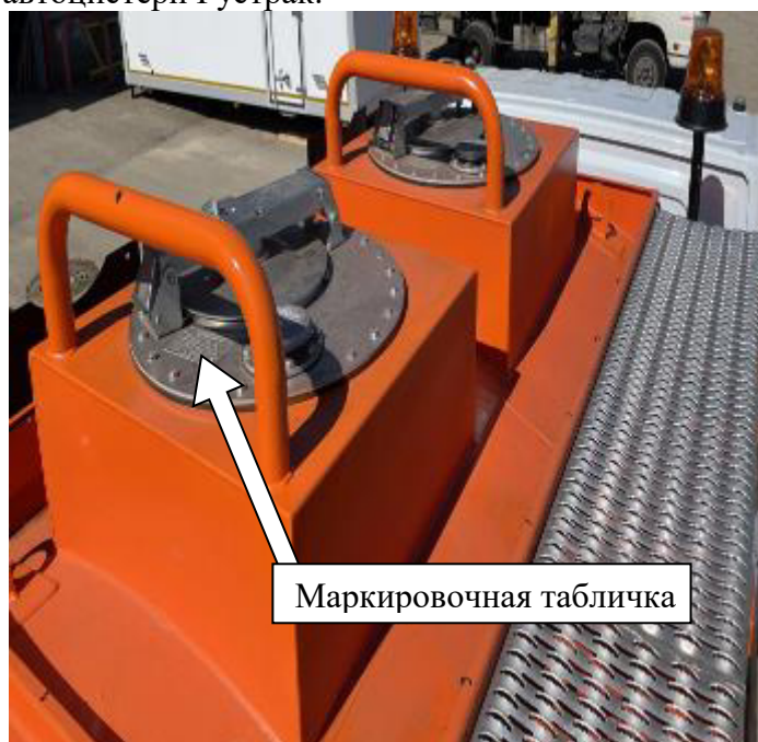
Рисунок 5 – Место установки маркировочной таблички
