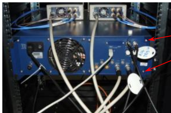
Рисунок 6 - Задняя панель ВАЦ С4420 (место пломбировки) с модулями расширения частотного диапазона
