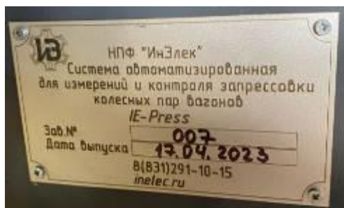
Рисунок 3 – Табличка-шильдик с маркировкой, заводским номером
