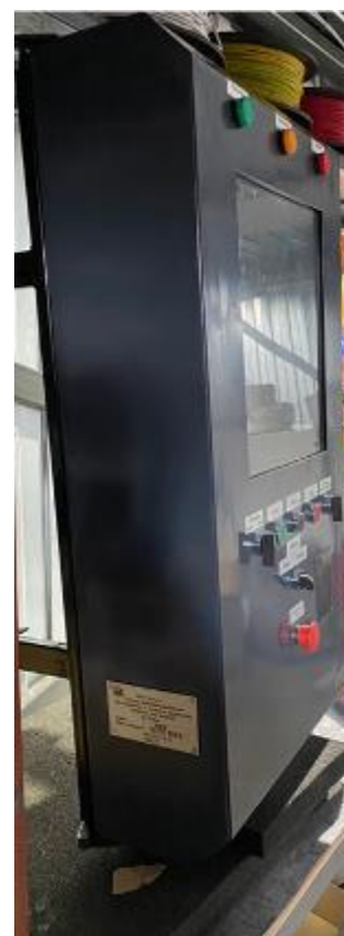
Рисунок 2 – Вид сбоку, место нанесения маркировки, заводского номера (табличка-шильдик)
