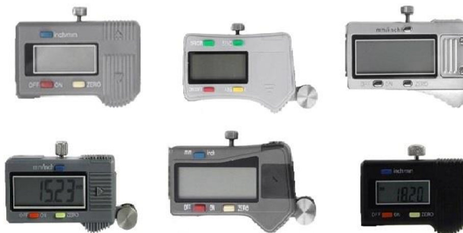
Рисунок 4 – Внешний вид корпуса цифрового отсчетного устройства штангенглубиномеров модели ШГЦ
