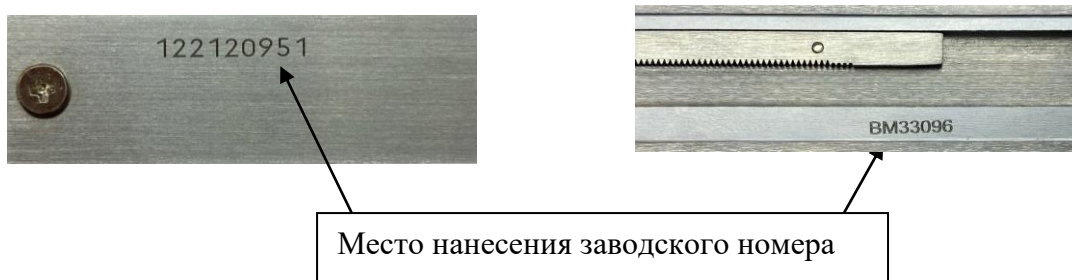
Рисунок 6 – Места нанесения заводского номера
