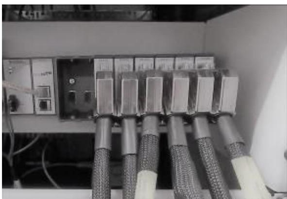
Рисунок 3 – Шасси NI cRIO-9145 с измерительными модулями NI 9205
