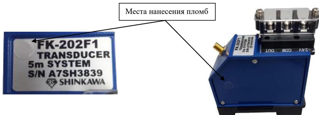
Рисунок 4 – Места нанесения пломб
