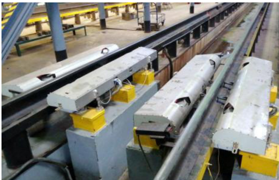
Рисунок 1 – Общий вид комплексов измерительных геометрических параметров колесных пар подвижного состава «Панопта» Нанесение знака поверки на средство измерений не предусмотрено.
