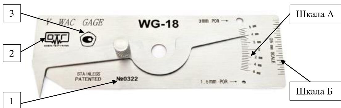
Рисунок 13 - Общий вид шаблона сварщика универсального WG, исполнение WG-18
