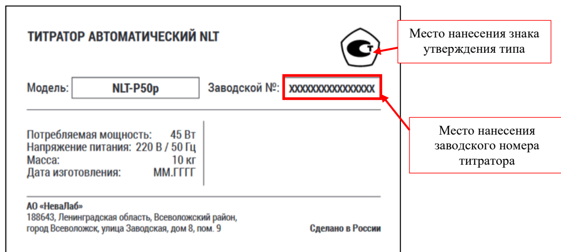
Рисунок 5 – Шильдик титратора автоматического NLT модели NLT-P50p
