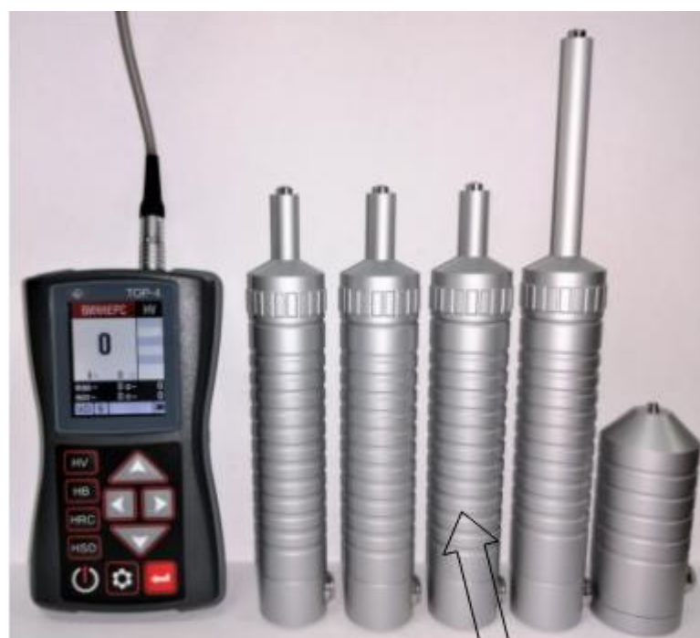
Датчики ультразвуковые (типы А, Н, С, АL, К)
