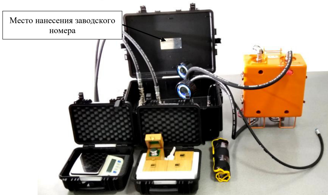
Рисунок 2 – Общий вид установки пикнометрической УИПП
