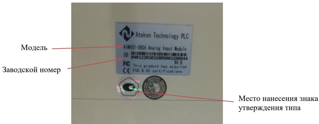
Рисунок 4 – Информационные сведения на корпусе модуля
