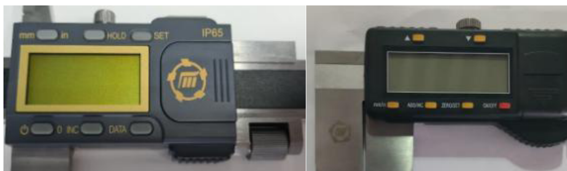
Рисунок 10 – Общий вид цифрового отсчетного устройства штангенциркулей (лист 1 из 2)
