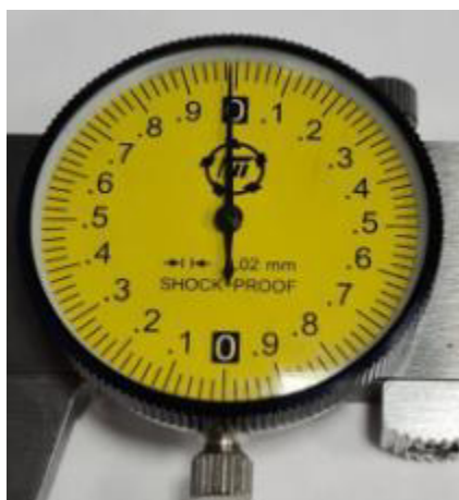
Рисунок 9 – Общий вид круговой шкалы отсчетного устройства штангенциркулей
