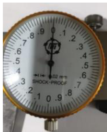
Рисунок 9 – Общий вид круговой шкалы отсчетного устройства штангенциркулей
