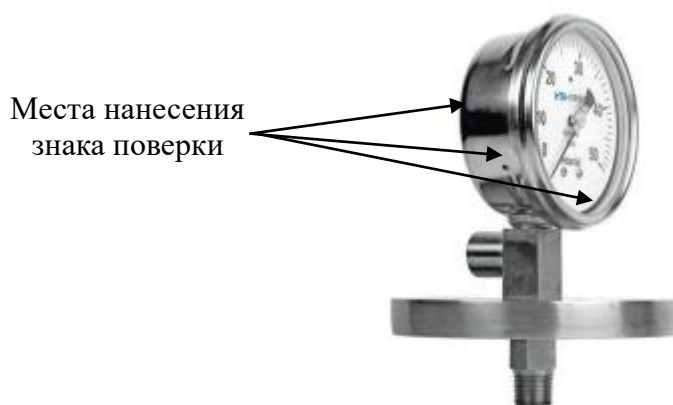
Рисунок 3 – Места нанесения знака поверки
