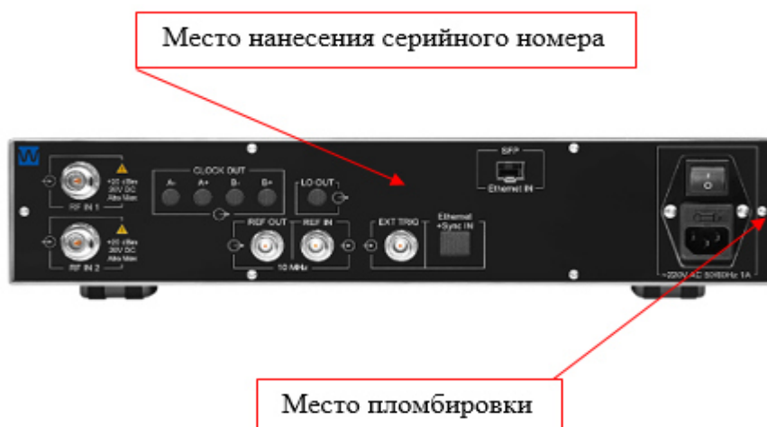
Рисунок 4 – Схема пломбировки от несанкционированного доступа и место нанесения серийного номера, идентифицирующего каждый экземпляр СИ приемников измерительных MWR модификаций MWR-40U, MWR-85U, MWR-100U, MWR-135U
