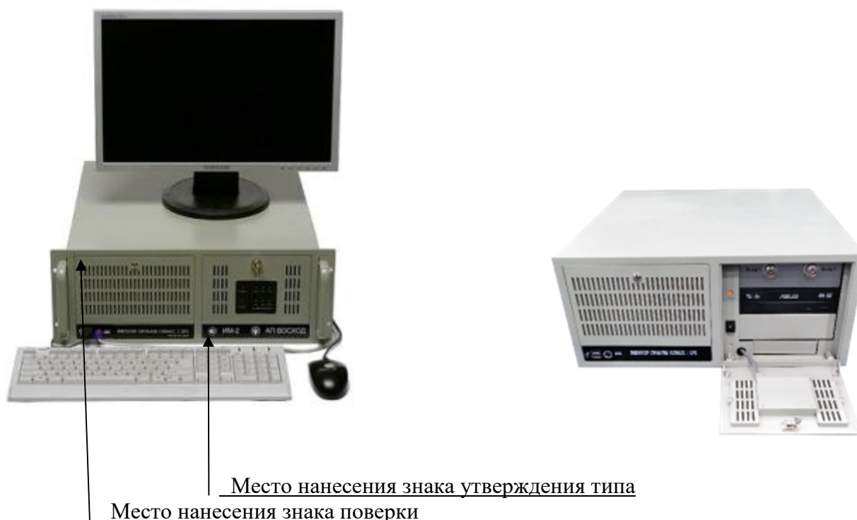
Рисунок 1 – Общий вид имитатора ИМ-2 с открытой и закрытой откидной крышкой БИ, обозначение мест нанесения знака утверждения типа, знака поверки
