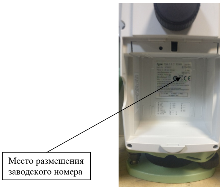
Рисунок 2 - Место размещения заводского номера
