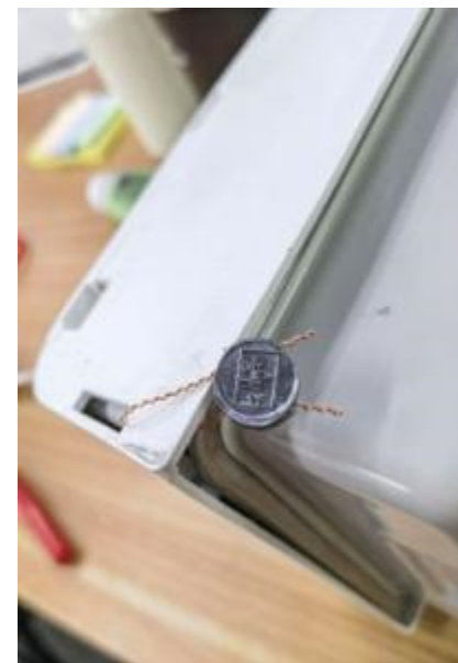
Рисунок 3 – Схема пломбирования счетчиков от несанкционированного доступа, обозначение места нанесения знака поверки
