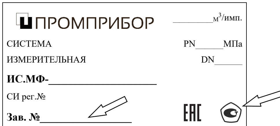
Рисунок 3 – Схема нанесения мест нанесения знака утверждения типа и заводского номера
