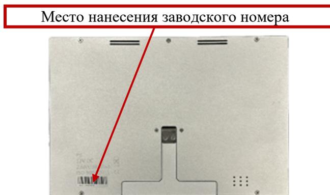
Рисунок 2 – Общий вид места нанесения заводского номера модулей моделей P2, P3
