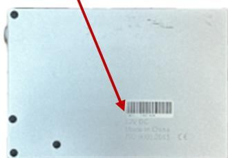
Рисунок 5 – Общий вид места нанесения заводского номера у многоканальных блоков моделей TAM8, TAM16
