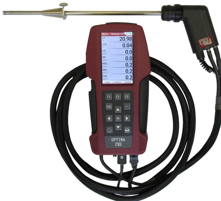
Рисунок 5 – Общий вид газоанализаторов с пробоотборным зондом
