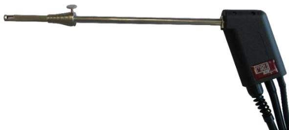
Рисунок 2 – Общий вид пробоотборного зонда с фиксированной трубкой
