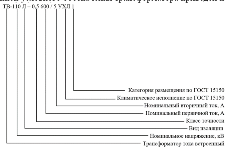
Рисунок 3 - Пример записи условного обозначения трансформатора
