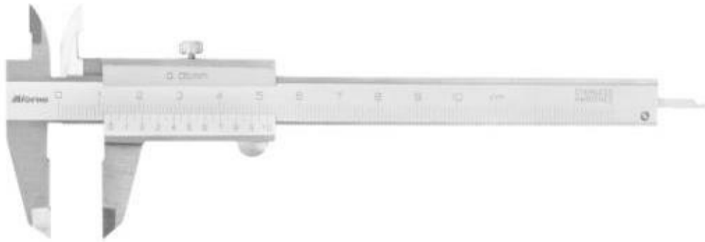
Рисунок 1 – Общий вид штангенциркулей модификации ШЦ-I со шкалой в миллиметрах и с цельно фрезерованной рамкой
