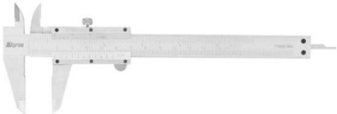
Рисунок 2 – Общий вид штангенциркулей модификации ШЦ-I со шкалой в миллиметрах, рамкой, соединённой винтами и дополнительной шкалой на штанге в дюймах
