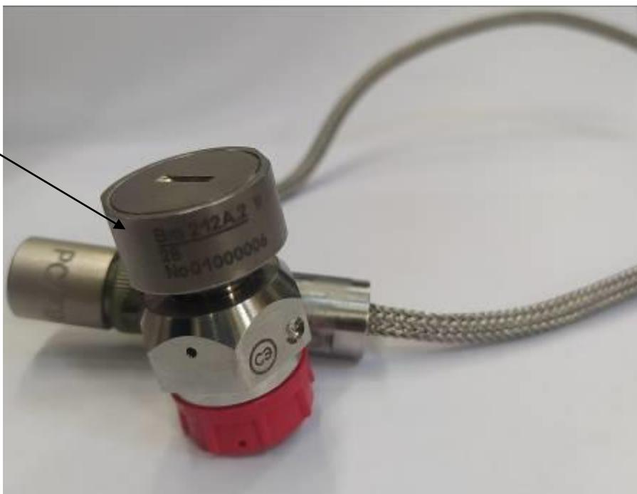
Рисунок 1 – Общий вид датчика Вм 212А.2.
