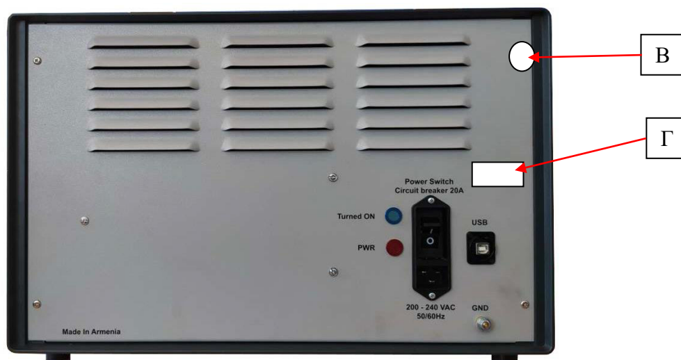
Рисунок 2 – Схема пломбировки от несанкционированного доступа (В) и место нанесения заводского номера (Г)
