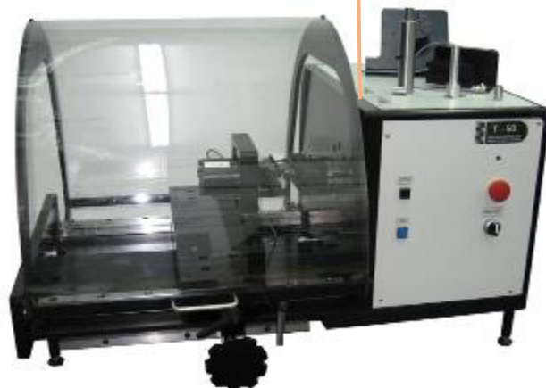
Рисунок 2 - Общий вид Машин для испытания пружин на кручение T Series, мод. T-50, T-100, T-200, T-50-Dual-Y, T-50-HS, T-50- Dual-Y-HS, T-100-Dual-Y, T-100-HS, T-100- Dual-Y-HS, T-200- Dual-Y, T-200-HS, T-200- Dual-Y-HS
