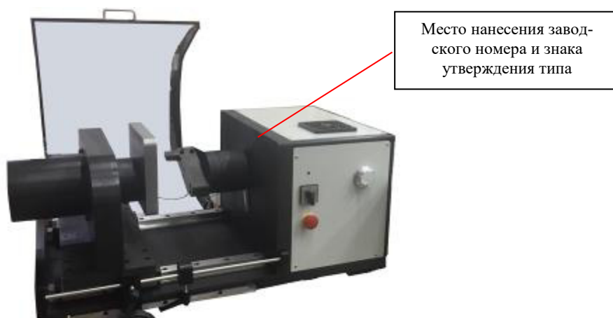
Рисунок 3 - Общий вид Машин для испытания пружин на кручение T Series, мод. T-500, T-500-Dual-Y, T-500-HS, T-500- Dual-Y-HS
