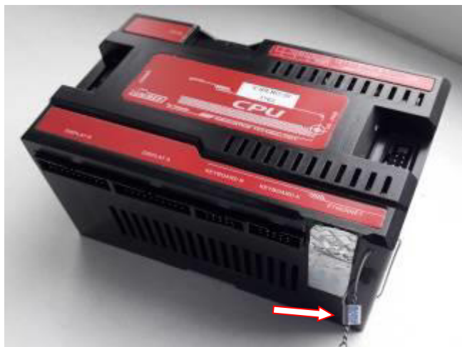
Рисунок 7 – Место нанесения знака поверки и пломбирования на крышку ЦП
