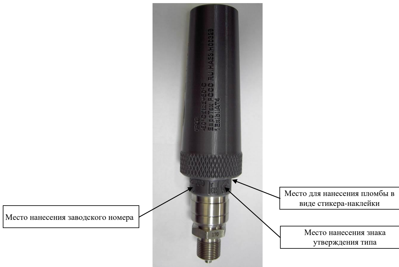
Рисунок 1 – Общий вид датчиков давления СМД модификации СМД ВН1225.600 с указанием места пломбировки, мест нанесения заводского номера и знака утверждения типа
