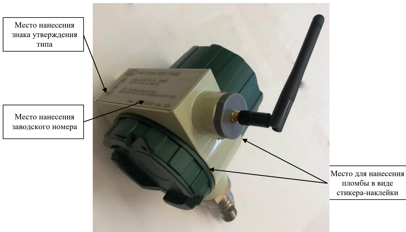
Рисунок 1 – Общий вид датчиков давления СМД модификации СМД ВН1226.600 с указанием места пломбировки, мест нанесения заводского номера и знака утверждения типа
