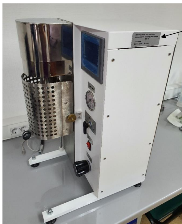
Рисунок 2 – Место нанесения заводского номера на реометры ротационные BSL R1
