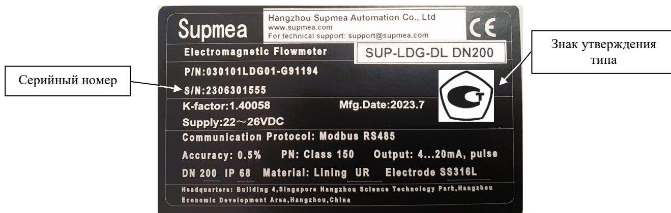
Рисунок 3 – Место нанесения серийного номера и знака утверждения типа
