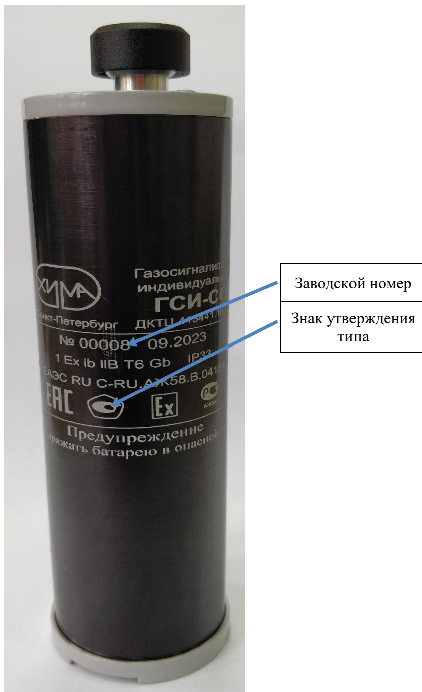
Рисунок 3 – Схема расположения заводского номера и знака утверждения типа
