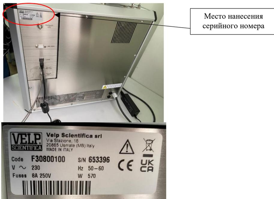
Рисунок 2 – Место нанесения маркировочной таблички с серийным номером
