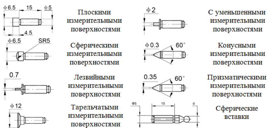
Рисунок 59 – Варианты исполнений измерительных поверхностей микрометров моделей МКД18, МКД18Ц
