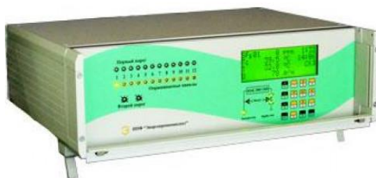
Рисунок 1 – Общий вид газоанализатора МАК-2000-UMS
